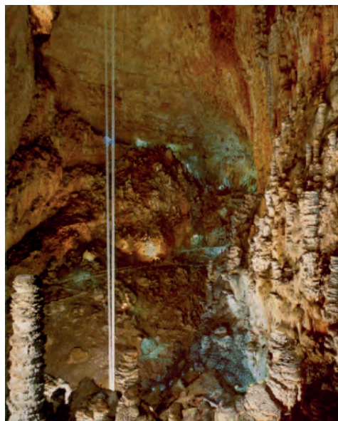
Grotta Gigante. Stazione Geodetica del Dipartimento di Matematica e Geoscienze dell'Università degli Studi di Trieste. Pendoli gravimetrici (foto CGEB).
