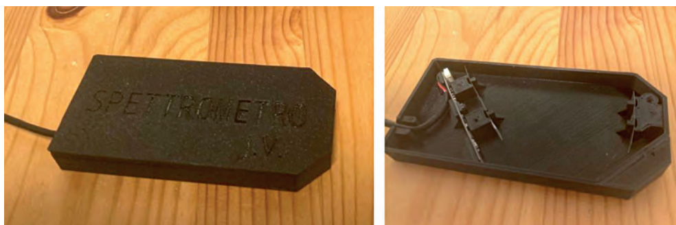
Fig. 2 - Spettrometro autocostruito usato per misurare lo spettro di emissione delle varie sorgenti luminose studiate durante le fasi preparatorie di questo progetto.
