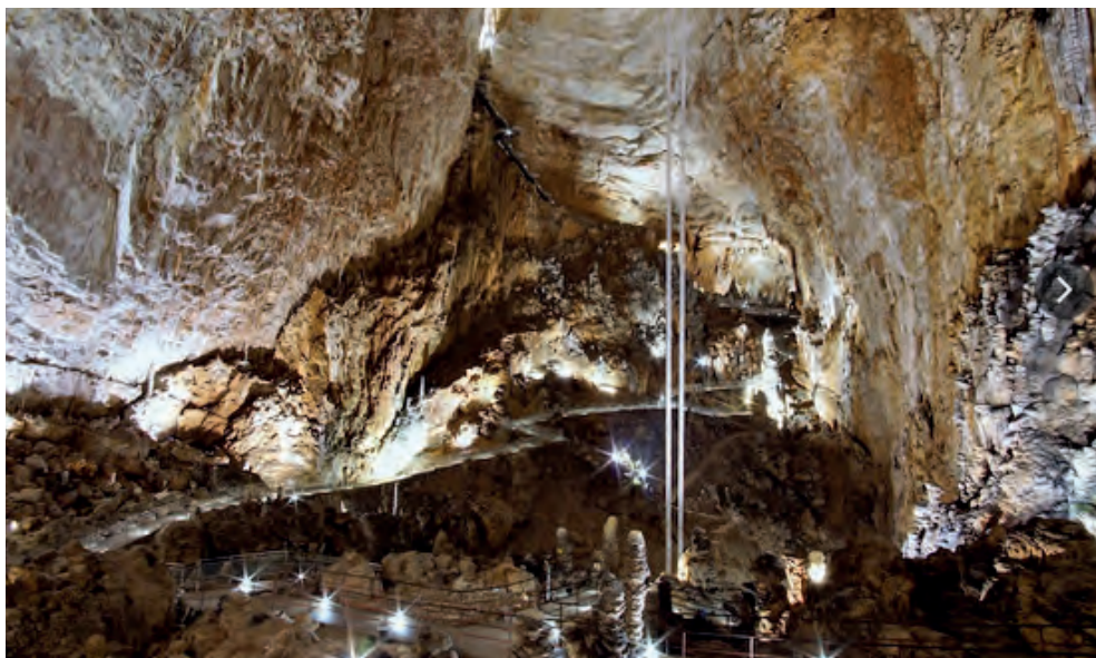
Grotta Gigante. Stazione Geodetica del Dipartimento di Matematica e Geoscienze dell'Università degli Studi di Trieste. Pendoli gravimetrici (foto CGEB).
