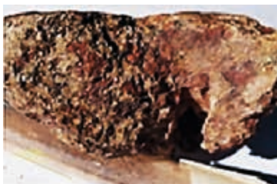
Fig. 54 a, b - Bauxite compatta, porosa, resistente alla percussione, peso specifico 2,2. Struttura composita, simile a masse pisolitiche irregolari rosso mattone immersi in pasta di fondo beige. All'esame microscopico in dettaglio la roccia si presenta costituita da ovoidi irregolari con tracce di accrescimento con concrezionamento concentrico, immersi in una sub microscopica matrice rosso mattone con sfumature tendenti al beige. L'esame diffrattometrico rivela essenzialmente una composizione mista di boehmite e goethite. È assente la fase calcitica.
