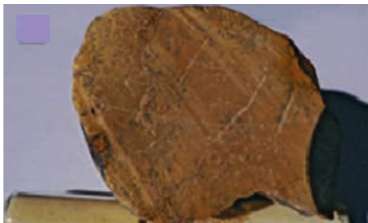
Fig. 53 a, b - Roccia argillosa, compatta, molto porosa, poco resistente alla percussione, friabile in alcune parti. Peso specifico 2,0. Tessitura plastica con lineazioni di tipo stilolitico e leggere differenziazioni minerali, rilevabili dalle sfumature cromatiche. Dal tipo di roccia sembra che sia presente un notevole contenuto di sostanze allo stato colloidale. L'esame diffrattometrico rivela essenzialmente calcite e quarzo. È probabile la presenza di fillosilicati.
