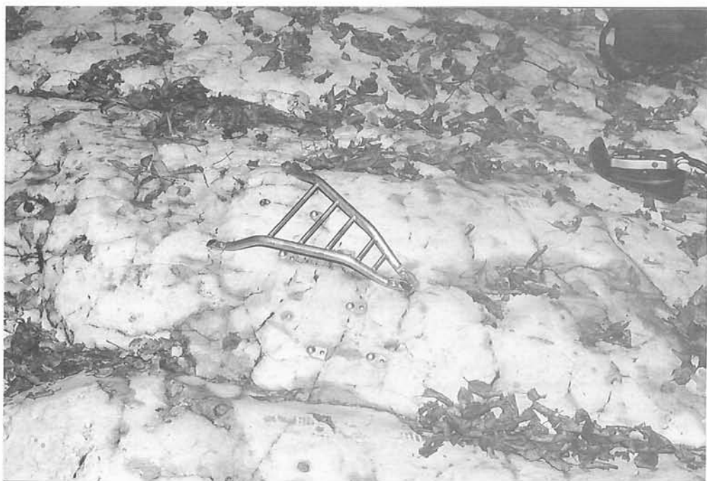
Stazione di misura per la dissoluzione carsica a Pradis
