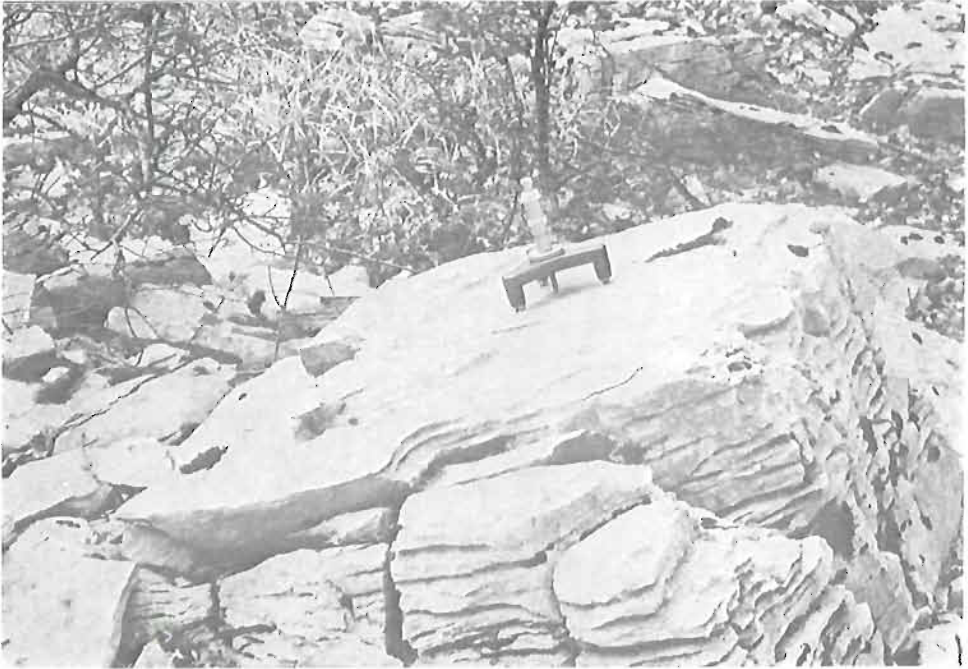
Micrometro in posizione di misura (STAZ. CN). Calcarei neri di tipo lagunare tra Borgo Grotta Gigante e Opicina.
