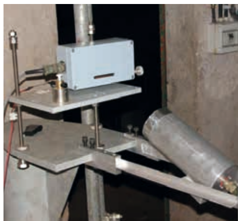
Grotta Gigante. Dispositivo di calibrazione di acquisizione digitale dei dati con una sorgente luminosa fissa di 4 Laser. (Foto: Dip. Scienze della Terra, Univ. Trieste ed Ist. Naz. di Geofisica e Vulcanologia).
