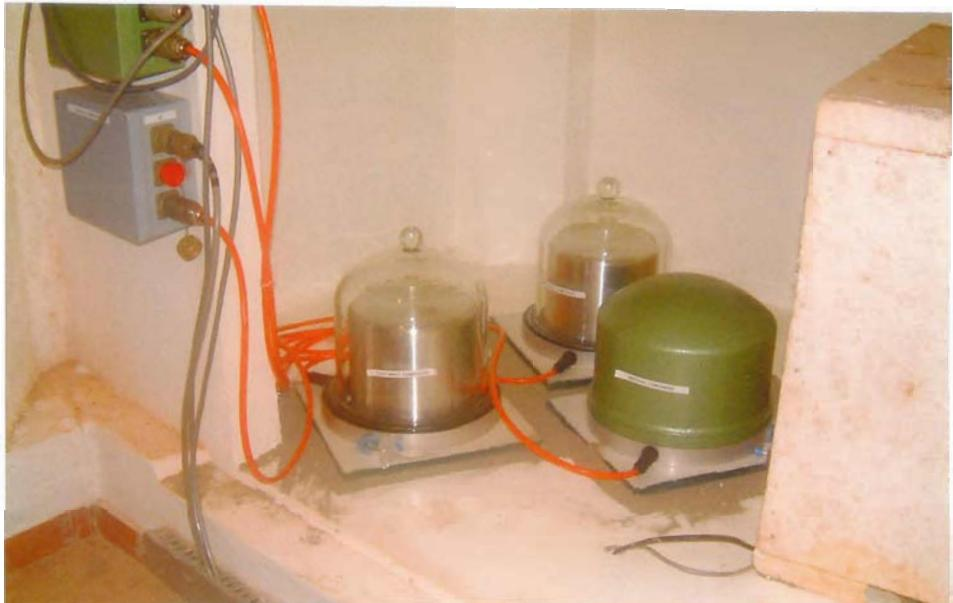
*I tre sensori digitali a larga banda (curva di risposta piatta su un ampio intervallo di frequenze) Streckeisen (componenti verticali, N-S ed E-O).*
