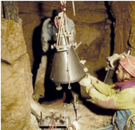
Fig. 1 - a) Clinometro Marussi durante la fase di messa in opera (sinistra); b) Visione della Grotta Gigante dall'alto con i pendoli della Grotta Gigante costruiti e progettati da Antonio Marussi.
