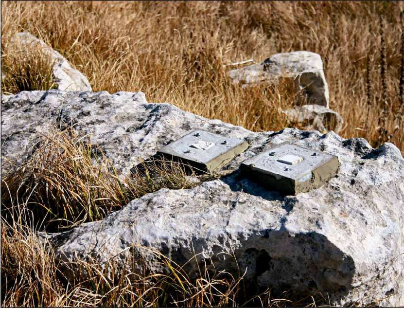
Fig. 3 - Stazione MEM su superficie fratturata (a sinistra) e tagliata (a destra), non colonizzate, preparate in laboratorio e riposizionate in campo.
