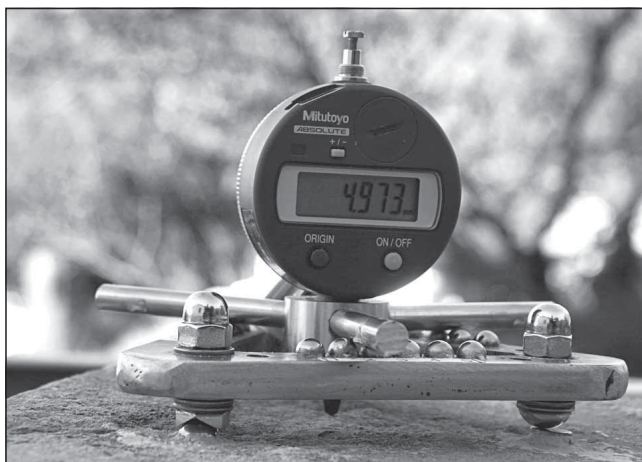
Fig. 2 - Lo strumento TMEM utilizzato in questo lavoro. Il telaio è progettato in modo da consentire fino a circa 200 misure su un'area di circa 2 cm 2 .
