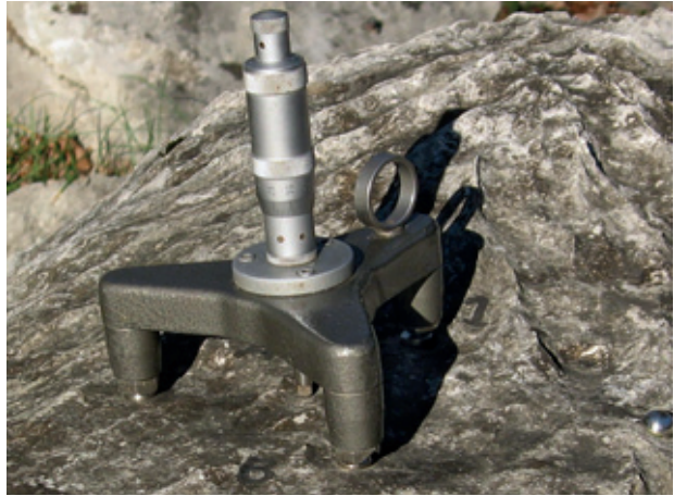
Fig. 1 - Stazione di Borgo Grotta Gigante: micrometro di misurazione del grado di consumazione di calcari in superficie (foto: CGEB). Nel suo genere è la stazione di misurazione più longeva in assoluto (oltre trent'anni di funzionamento e di raccolta dati).
